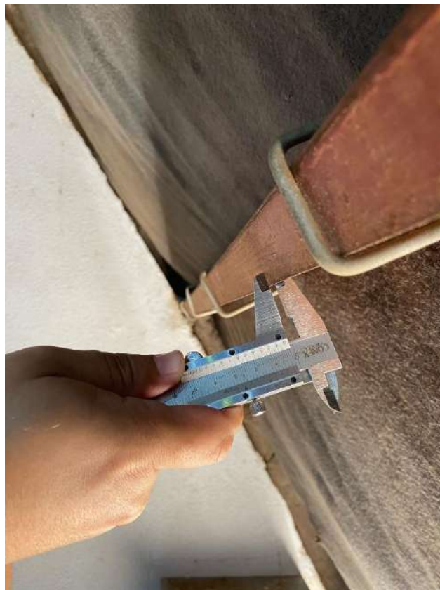
Imagem 19- Aferição de medida terça metálica
