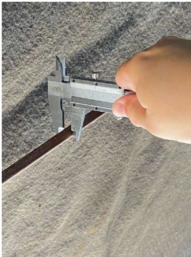
Imagem 27 - Aferição da espessura dos Contraventamentos
